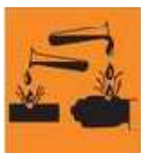
e. Bahaya korosi
