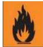
c. Bahaya Kebakaran
